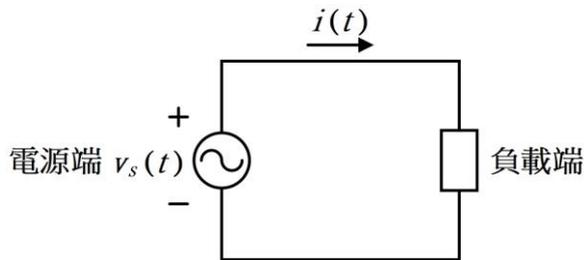
123. (124) 有一負載之端電壓及端電流分別為  $v(t) = 240\sqrt{2}\cos(\omega t) + 80\sqrt{2}\cos(3\omega t)V$  及  $i(t) = 60\sqrt{2}\cos(\omega t - 30^\circ) + 20\sqrt{2}\cos(3\omega t + 30^\circ) + 12\sqrt{2}\cos(5\omega t - 60^\circ) + 9\sqrt{2}(7\omega t)A$ ，式中  $\omega=377\text{rad/s}$ ，下列哪些正確？ ①端電壓有效值約為 253V ②電流總諧波失真約為 0.4167 ③送至負載之平均功率約為 21500W ④功率因數約為 0.843。
