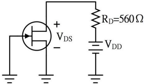
51. (1) 2N5459 的 JFET， $I_{DSS} = 9mA$ ， $V_{GS(OFF)} = -8V$ ，則  $V_{GS} = -4V$  時的汲極電流為 ① 2.25mA ② 4.5mA ③ 9mA ④ 13.5mA。
