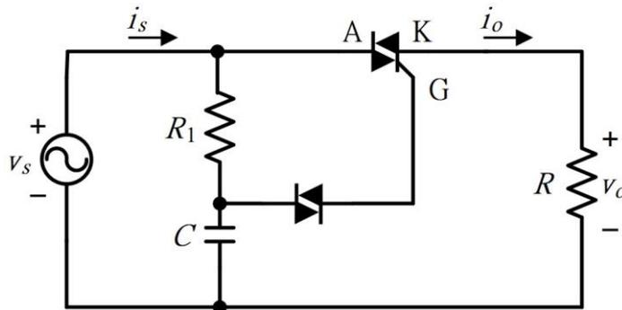
134. (134) 下圖所示之單相交流電壓控制器 (AC voltage controller)，接電阻性負載，下列哪些正確？ ①可採導通-截止 (on-off) 或相位控制 (phase control) 兩種控制模式 ②兩 SCR 可同時導通 ③兩 SCR 分別導通時間若相同，電源與負載之電流平均值為 0A ④兩 SCR 分別導通時間若相同，則流過每個 SCR 之電流有效值為負載電流有效值的  $\frac{1}{\sqrt{2}}$  倍。
