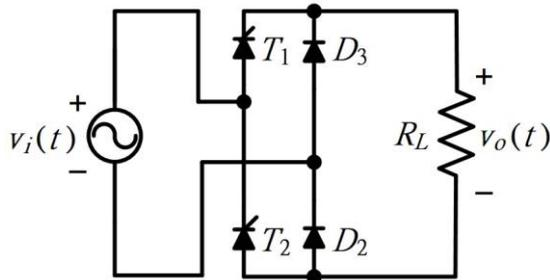
133. (124) 下圖所示之交流電壓控制器電路，電源  $v_s(t) = \sqrt{2} 110\sin(2\pi 60t)V$ ，負載  $R=5\Omega$ ，閘流體激發延遲角調在  $\alpha=60^\circ$ ，下列哪些正確？ ①負載端電壓有效值約為 99V ②負載端電壓平均值為 0V ③負載之平均功率為 0W ④電源側功率因數約為 0.9。
