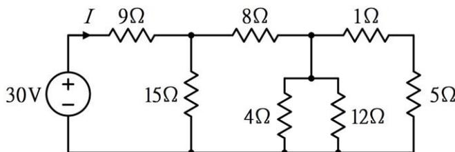
88. (134) 下圖所示電路的  $I$ 、 $V_1$ 、 $V_2$  及  $V_3$  之值，下列哪些正確？ ①  $I=9A$  ②  $V_1=20V$  ③  $V_2=27V$  ④  $V_3=18V$ 。
