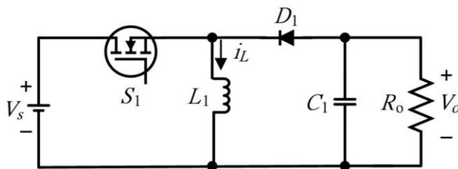
104. (14) 下圖為降升壓轉換器 (buck-boost converter)，在穩態操作且電感電流  $i_L$  為連續， $d_1$  為開關元件  $S_1$  的導通責任週期， $T_s$  為開關切換週期， $f_s$  為切換頻率，電感電流為臨界條件時的電感最小值  $L_{min}$  及輸出電壓的漣波  $\Delta V_o$  為
