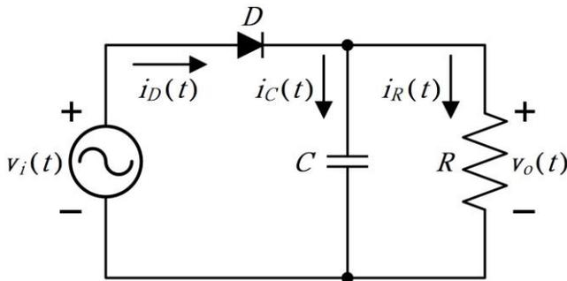
150. (13) 下圖所示之具有濾波電容橋式全波整流電路，輸入電源為  $v_i(t) = V_m \sin(\omega t) \text{V}$ ， $\omega = 2\pi f$ ， $f$  表示頻率 (Hz)，下列哪些正確？ ①二極體導通時，輸出電壓為  $|V_m \sin(\omega t)| \text{V}$  ②二極體截止時，輸出電壓為 0V ③峰對峰值輸出漣波電壓約為  $\frac{V_m}{2fRC}$  ④二極體電流為正弦波。
