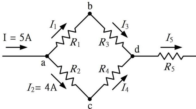
86. (23) 下圖所示並聯電路，求等效電阻、電流  $I$ 、 $I_1$ 、 $I_2$ 、 $I_3$  及電流電源供給的功率為
