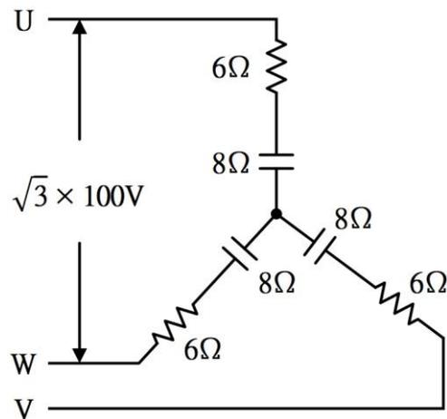
54. (2) 下圖所示電路中，分支電流  $I_2$  為多少安培？ ① 4 ② 8 ③ 10 ④ 16。
