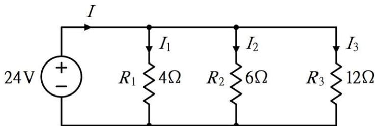
87. (34) 下圖所示串並聯電路，由電源兩端看入的等效電阻為  $R_T$ ，電流為  $I$ ，下列哪些正確？
