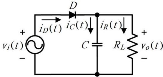
128. (124) 下圖所示之具有濾波電容橋式全波整流電路，輸入正弦波電源電壓有效值為  $120\text{V}$ ， $R_L=100\Omega$ ， $C=100\mu\text{F}$ ，下列哪些正確？ ①輸出電壓平均值約為  $168\text{V}$  ②負載電流愈大，輸出漣波電壓愈大 ③若增大濾波電容，輸出漣波電壓變大 ④二極體電流為脈波。
