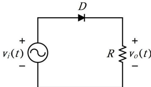
148. (34) 下圖所示之單相半波整流電路具有電感及電阻串聯負載，輸入電源為  $v_i(t) = V_m \sin(\omega t)V$ ，關於電流  $i(t)$  之特性，下列哪些正確？ ①僅有強迫響應 (forced response) ②僅有自然響應 (natural response) ③為強迫響應與
