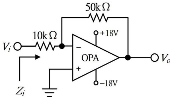
77. (12) 下圖所示電路中，下列哪些敘述正確？ ①該電路為非反相放大器 ②電壓增益為  $1+(R_2/R_1)$  ③該電路為反相放大器 ④電壓增益為  $1+(R_1/R_2)$  。
