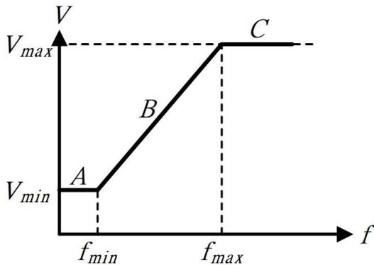
34. (1) 下圖感應電動機  $V/f$  曲線中，哪一區段曲線屬於低速轉矩提昇區？ ①  $A$  ②  $B$  ③  $C$  ④  $A$  及  $B$ 。
