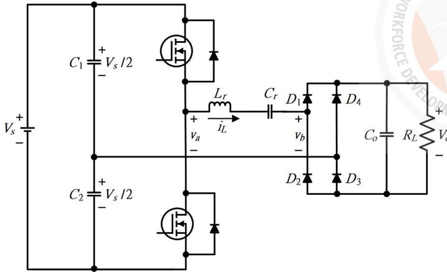
110. (13) 串聯諧振式直流-直流 (dc-dc) 轉換器，下圖所示穩態的交流電路，其基本波振幅  $V_{b1}$  及  $V_{a1}$  的關係，下列哪些正確？ ①  $\frac{V_{b1}}{V_{a1}} = \frac{R_e}{|R_e + j(X_L - X_C)|}$  ②
