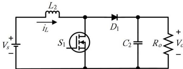
100. (14) 下列關於升壓型轉換器之敘述，哪些正確？ ①輸出電壓高於輸入電壓 ②輸出電壓低於輸入電壓 ③電感越小，其電感電流越容易連續 ④電感越大，其電感電流越容易連續。
