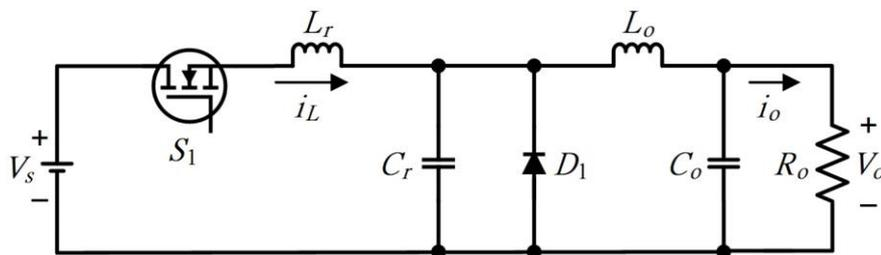
109. (12) 下圖為串聯諧振式直流-直流 (dc-dc) 轉換器的電路，此電路的諧振頻率  $f_o$  及角頻率  $\omega_o$  為 ①  $f_o = \frac{1}{2\pi\sqrt{L_r C_r}}$  ②  $\omega_o = \frac{1}{\sqrt{L_r C_r}}$  ③  $f_o = \sqrt{\frac{L_r}{C_r}}$  ④  $\omega_o = \sqrt{\frac{L_r}{C_r}}$ 。
