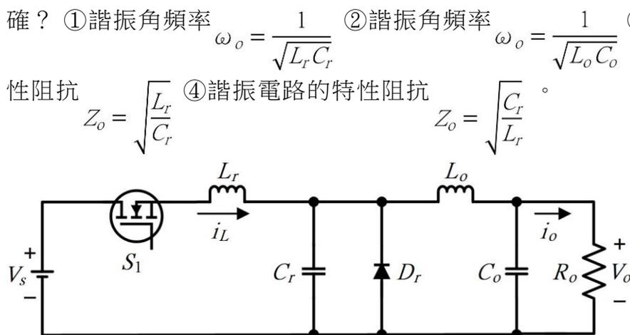
108. (14) 下圖為諧振式轉換器，關於開關元件  $S_1$  的切換過程，下列哪些正確？ ①電感  $L_r$  的電流  $i_L$  為零時，開關元件  $S_1$  截止 ②電感  $L_r$  的電流  $i_L$  為零時，開關元件  $S_1$  導通 ③此開關元件  $S_1$  為零電壓切換 ④此開關元件  $S_1$  為零電流切換。
