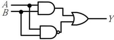
49. (1) 下圖之邏輯閘之布林 (Boolean) 函數為 ①  $Y = A \oplus B$  ②  $Y = A + B$  ③  $Y = A \cdot B$  ④  $Y = \overline{A} + \overline{B}$  。
