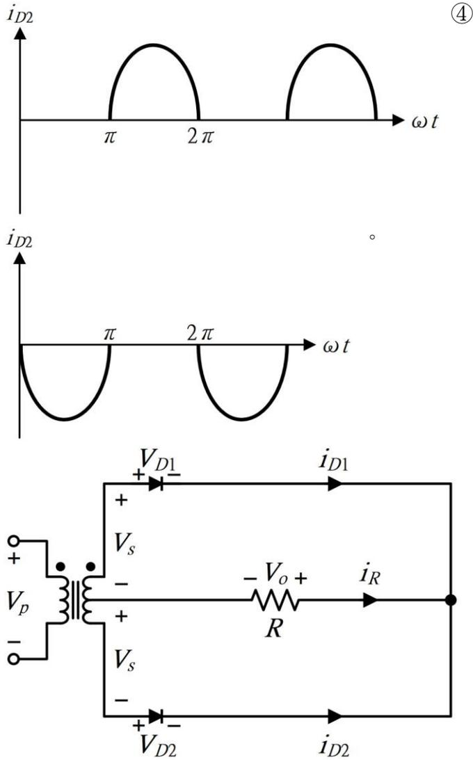
55. (4) 下圖所示電路中，若  $V_s = V_m \sin \omega t$ ，則  $V_{D2}$  的波形為何？ ①
