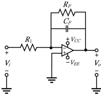
37. (14) 下圖所示回授電路，下列哪些敘述正確？ ①該電路為負回授電路 ②該電路為正回授電路 ③該電路之閉迴路增益為  $A/(1-\beta A)$  ④該電路之閉迴路增益為  $A/(1+\beta A)$ 。
